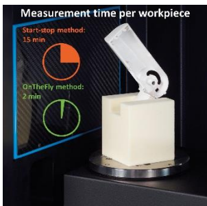
【高速スキャンオプションOn The Fly(通常スキャンとの測定時間と精度の比較)】
